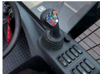
Kapazitiver Joystick und Armlehne mit Drehdrücksteller für Schnellzugriff auf Innenraumtemperatur, Lüftungsregelung und Licht.
