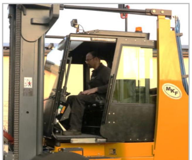
Kabine mit Komfortsitz, optional mit Klimaanlage, Heizung, Fahrersicherungsbügel, Standard- oder Schiebetür.
