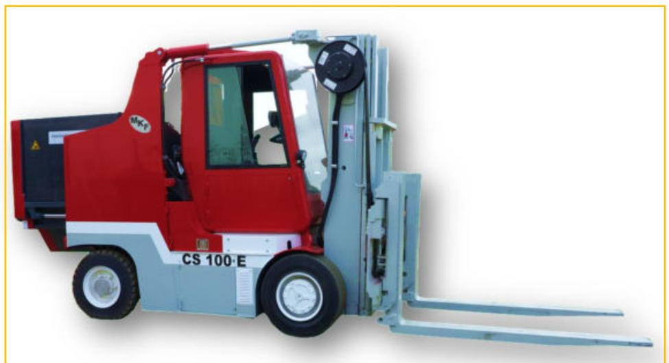
Durch unseren patentierten hydrostatischen Elektroantrieb weisen MKF Elektrostapler die gleichen Leistungswerte auf wie MKF Gas- und Dieselstapler.
