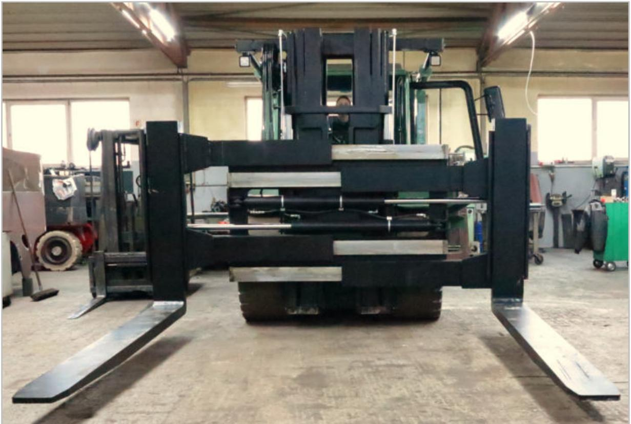
Maximale Gabelverstellung eines MKF 20 Tonnen Elektrostackers.
