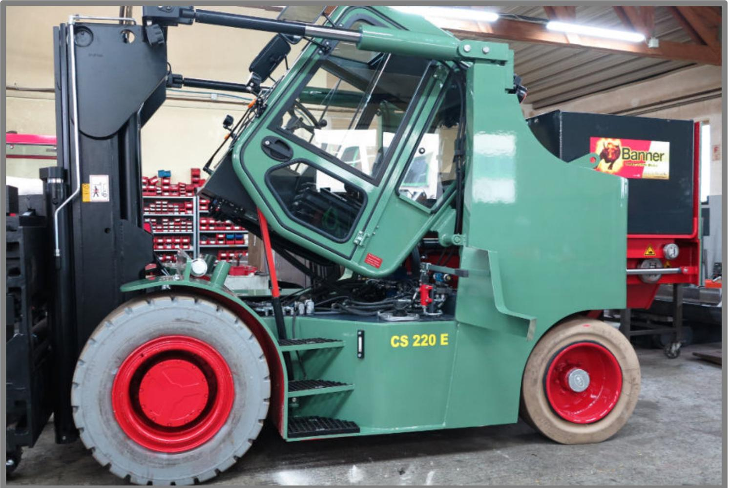
Die Kabinen der MKF Stapler werden mit einer hydraulischen Pumpe angehoben.
