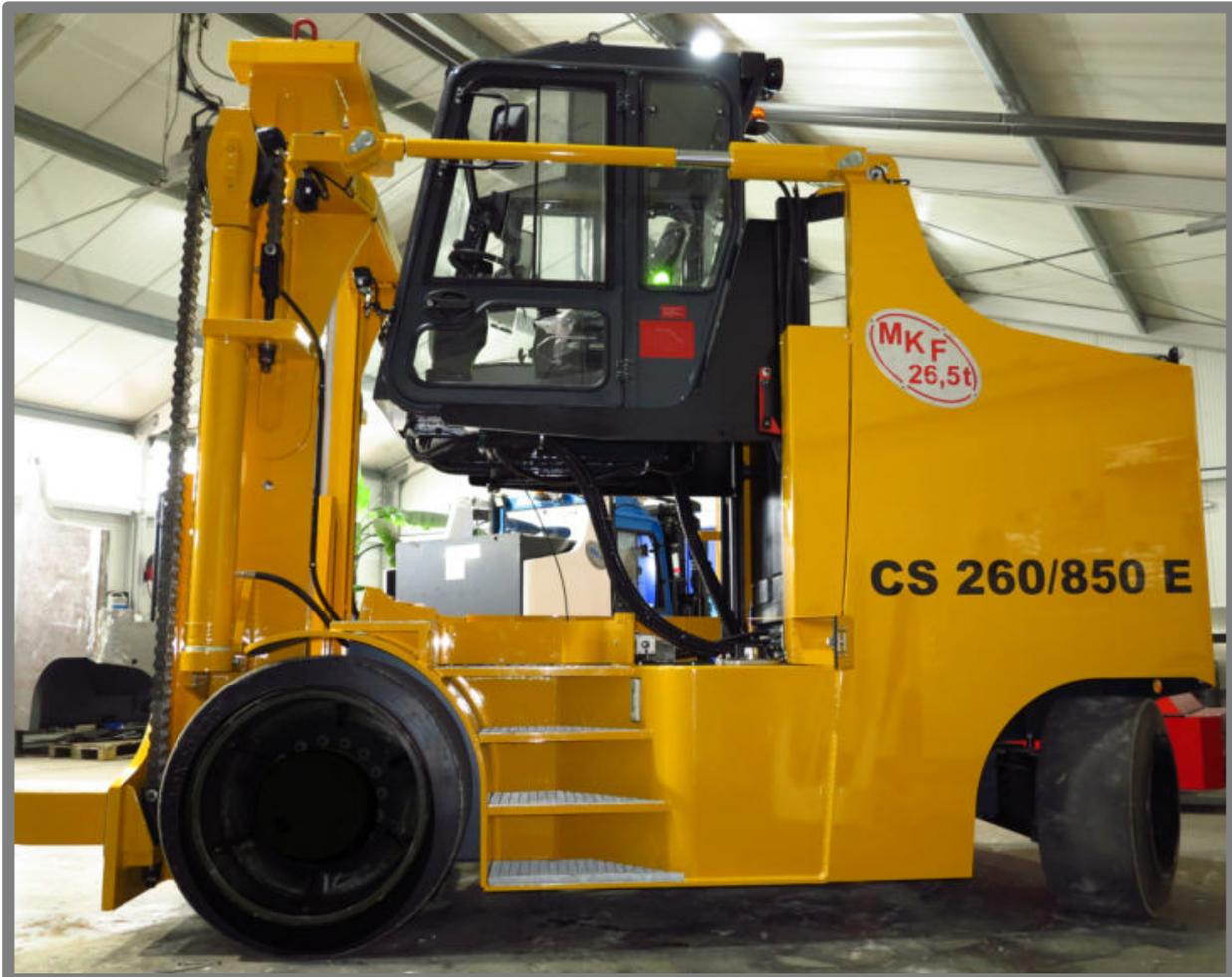
Die Kabinen der MKF Stapler können werden mit einer hydraulischen Pumpe angehoben.
